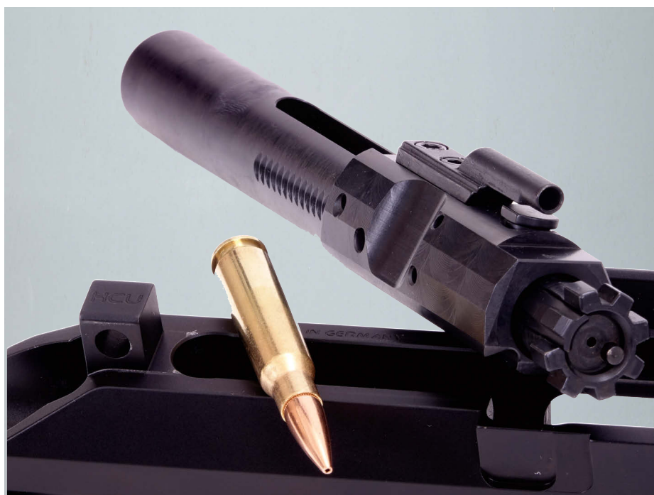
Die Verschlussgruppen aller 7SIX2-Modelle werden in einer Magnetpulverprüfung auf Risse inspiziert (MPI; Magnetic Particel Inspection), nach militärischen Spezifikationen verdichtet sowie nitriert.
