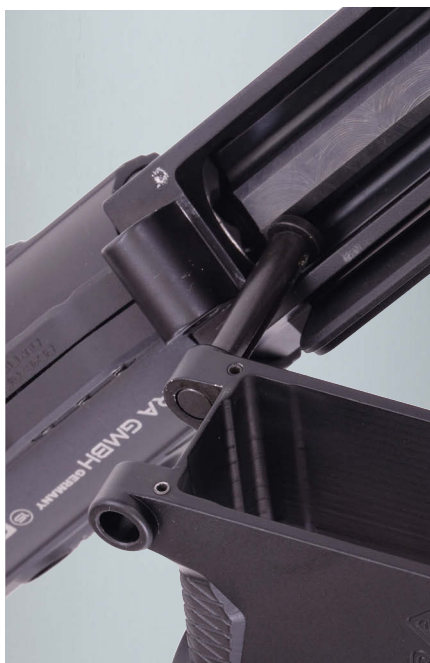
Diese beiden Stiftschrauben im Griffstück sorgen für einen Toleranzausgleich zwischen Lower und Upper.
