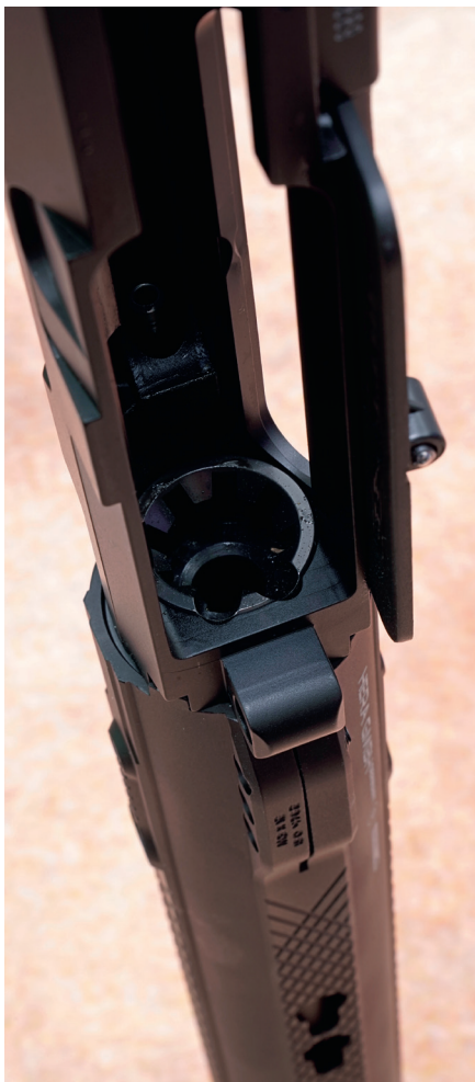
Tadellose Funktion: Der standardmäßige AR-15-Verschluss und die sauber gefertigten Rampen im „Upper“.
