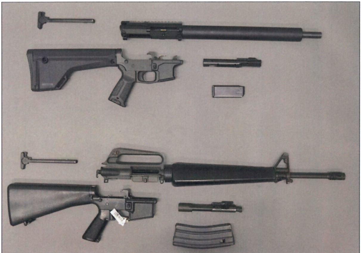
Abbildung 9: oben „The 9ers-Sport“, unten „AR15“, zerlegt in Hauptbaugruppen
