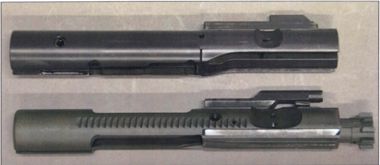
Abbildung 5: Gesamtansicht Verschlüsse rechte Seite, oben „The 9ers-Sport“, unten „AR15“
