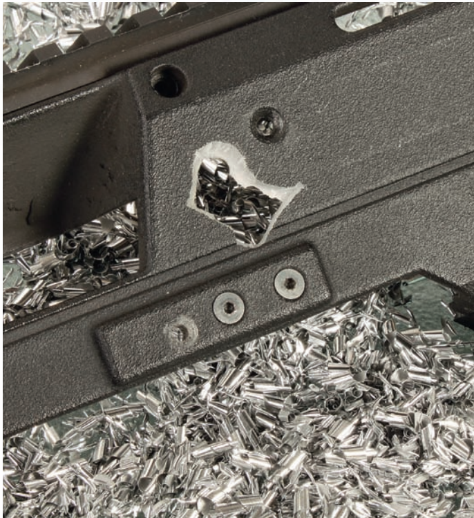
Zu den Versuchsreihen, die Hera-Arms fuhr, gehörten provozierte Gehäuse-Zerstörungen, wobei ohne Inlays und/oder Hülse beziehungsweise mit "Innencomp" geschossen wurde.
