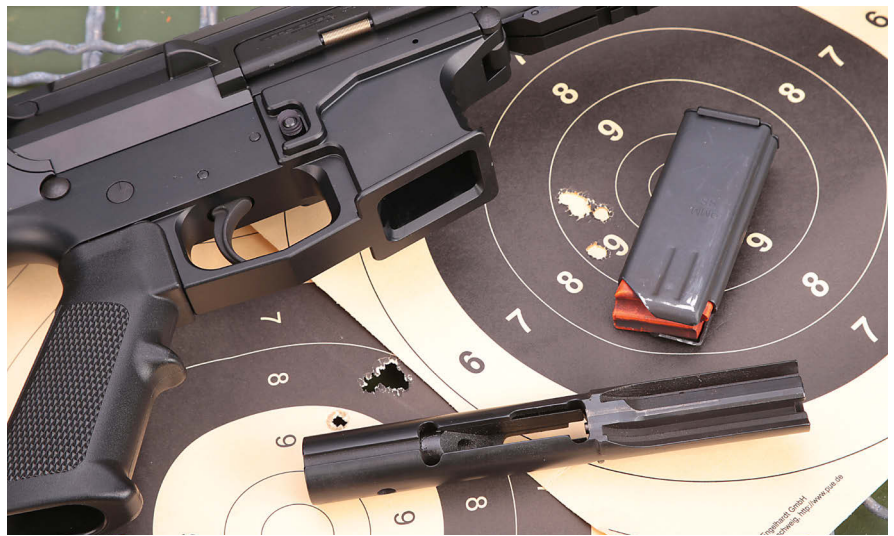
Die Karabiner „The9ers“ von Hera Arms arbeiten mit einem unverriegelten Masserverschluss. Anders als bei AR-15 in 9 mm Luger sonst üblich fertigt Hera Lower Receiver, die den Magazinen für die Pistolenpatrone auf den Leib geschneidert sind.
