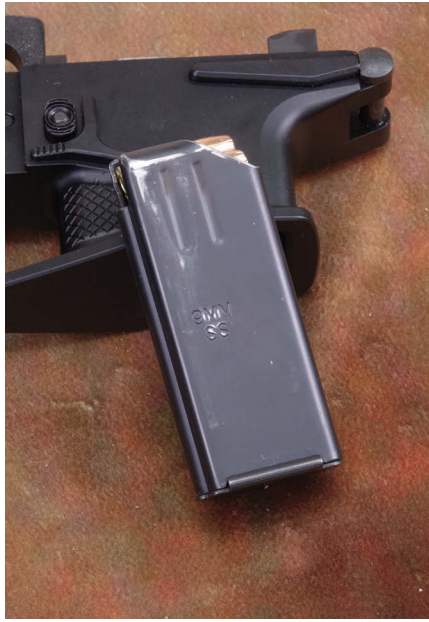
Der Karabiner wird mit modifizierten, auf 10 Patronen begrenzten Stahlblechmagazinen der UZI-Maschinenpistole gefüttert.
